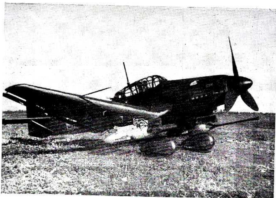
Der neue Vogel: die Ju 87, Baureihe G. Zur Panzerbekämpfung sind zwei 3,7 cm Flakkanonen unter den Flächen so angeordnet, daß sie in 400 m Entfernung den gleichen Punkt treffen. Bei meiner Maschine war diese Entfernung meistens bis auf 100 m verringert.
